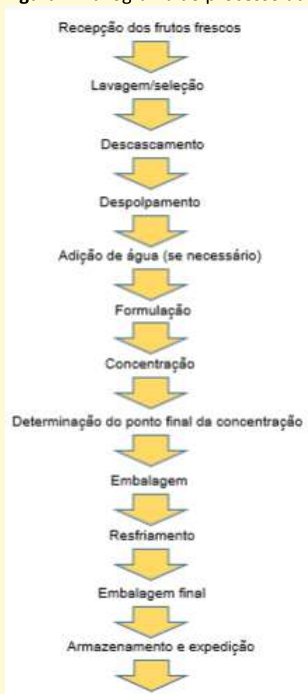
Figura 4 Fluxograma do processo utilizado neste trabalho
